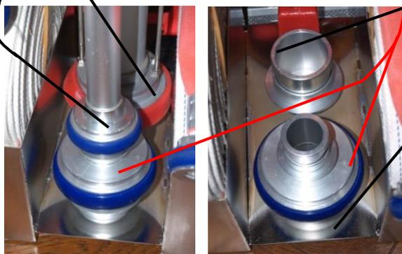
収納キャリアの底に固定された円筒金具
