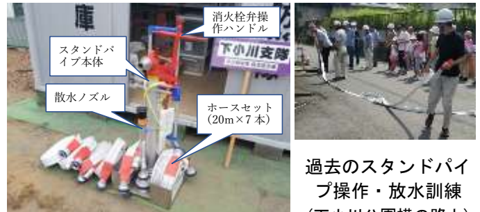
スタンドパイプ消火機材一式 (下小川公園防災倉庫保管)
